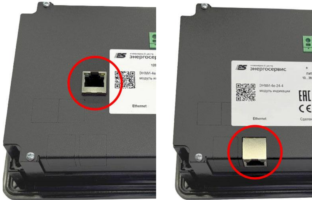
Рисунок 1.9. Расположение интерфейсного разъема ЭНМИ-4...-4. Слева – до 2025 года, справа с 2025 года.
